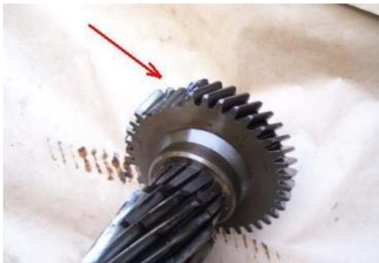
Рис. 5. Разрушение зубчатого колеса в следствие повышенных нагрузок и несоответствие системы и подачи смазки
