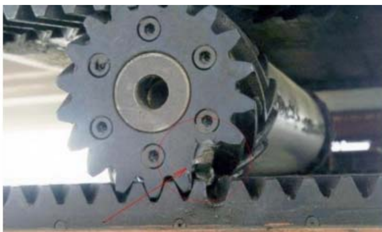
Рис. 6. Излом зубчатого зацепления в следствие повышенных нагрузок и несоответствия твердых смазок
